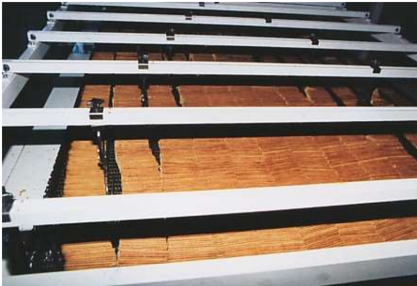
Canalización de los crackers
