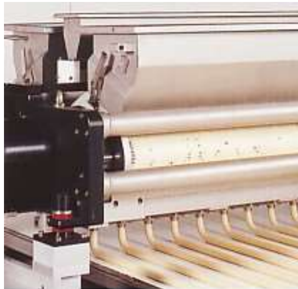
Mismo funcionamiento, pero SIN CORTE (SIN ALAMBRE): LINEAS CONTINUAS DE MASA Corte antes / después del horneado
