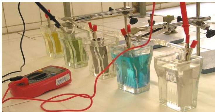
El puente salino conectará entre sí las semiceldas. Se construirá utilizando tubos de vidrio rellenos de una disolución saturada de KCl y taponando la salida mediante algodón. De este modo tendremos interconectadas todas las semiceldas y podremos por lo tanto medir las diferencias de potencial de las pilas que se forman al combinar cualquiera de estas semiceldas.
