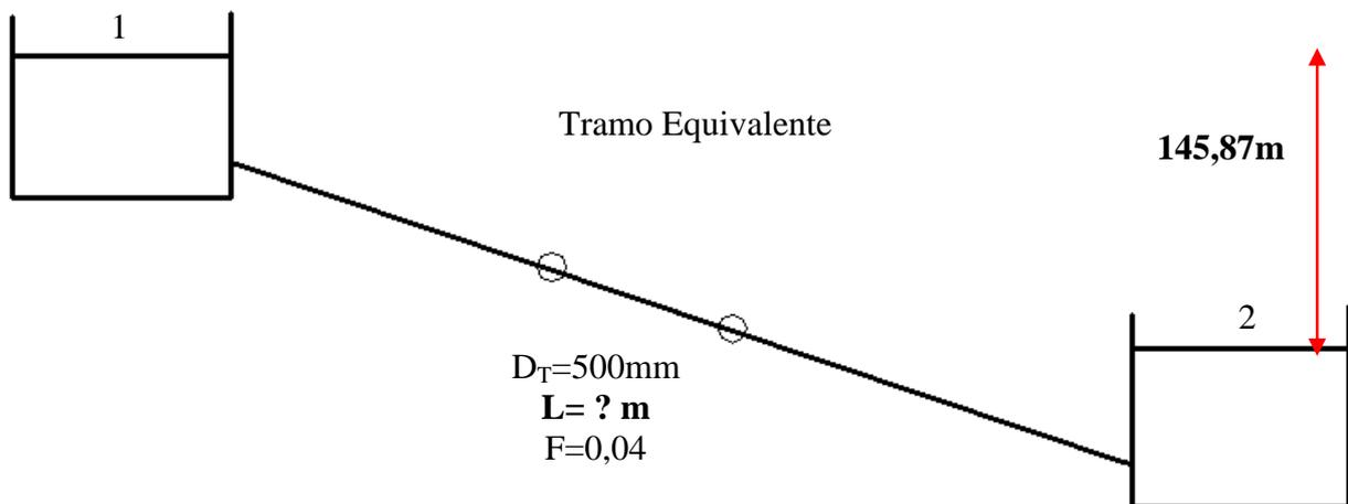
Calculamos un tramo de tubería equivalente a las tuberías en paralelo.
