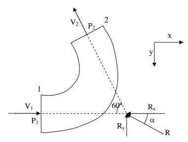
4. La figura representa la boca de un cañón de riego o enrollador. La manguera tiene un diámetro interior de 76 mm y la boquilla produce en chorro de 38 mm de diámetro. Determinar la fuerza longitudinal en Newtons que debe aguantar la junta situada en la base de la boca del cañón si el caudal de diseño es de 1135 l/min.
