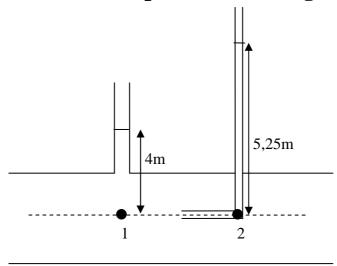
¿Y si en el punto 1 colocamos un manómetro y mide 50 kPa?
