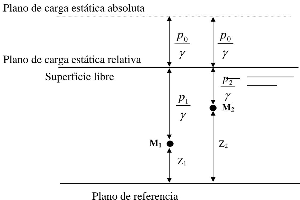
2. La diferencia de presión entre dos puntos de un fluido viene dada por el peso de una columna de dicho líquido de base unidad y altura igual a la diferencia de nivel entre ambas. Si uno de los puntos está en la superficie libre, sometido a la presión atmosférica,  $p_0$ , y el otro a una profundidad  $h$ , la presión será:
