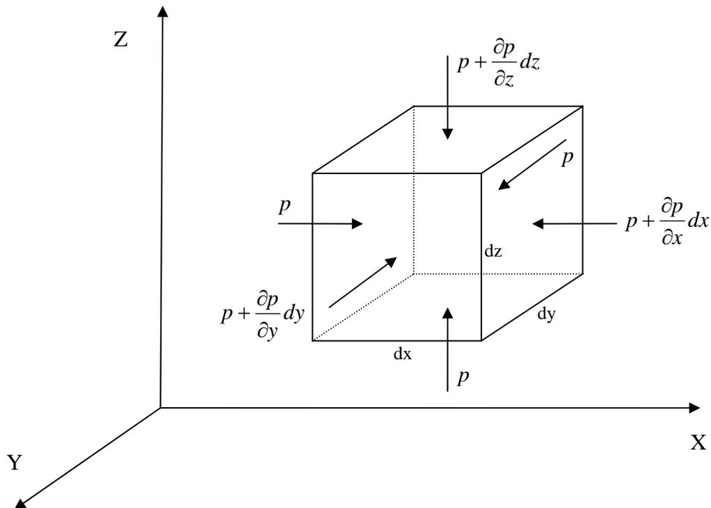
La figura representa un volumen elemental dentro de un fluido en reposo. Estará sometido a las presiones que sobre sus caras ejerce el resto del fluido y a la acción de las fuerzas exteriores  $\vec{F}(X, Y, Z)$ .
