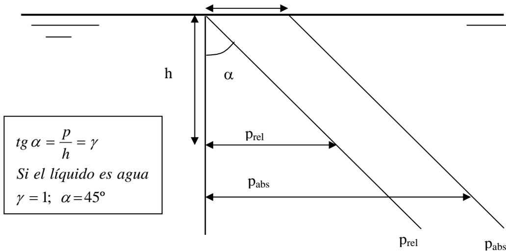
Distribución de presiones en la vertical de un líquido homogéneo
