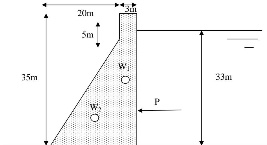
Primero determinamos como se define el coeficiente de estabilidad al vuelco
