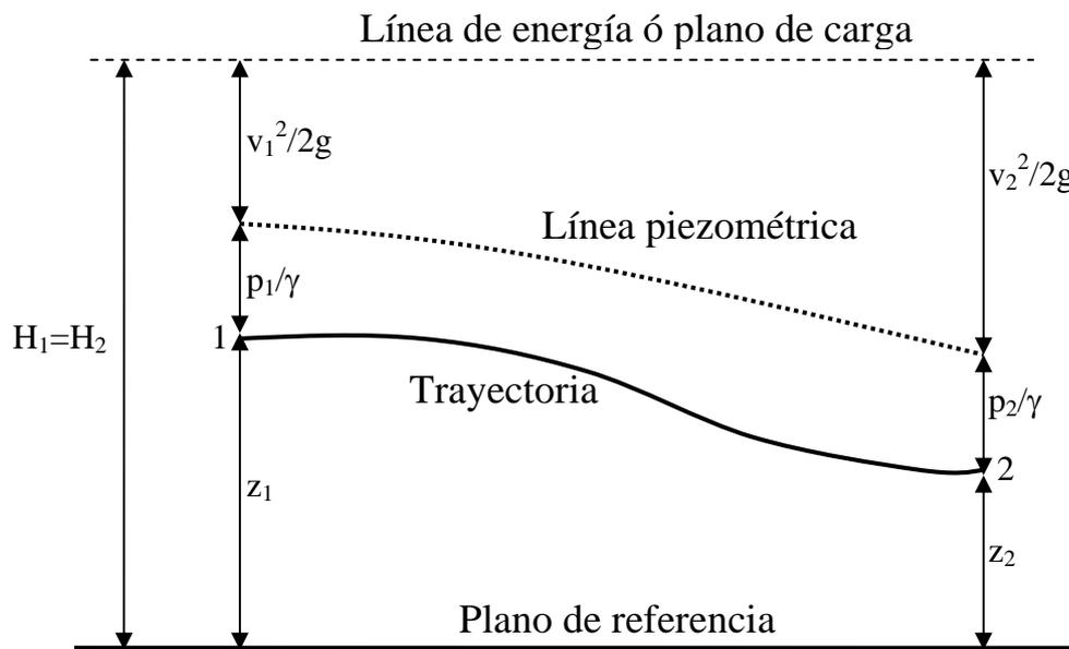
Si bien la suma de las tres alturas se mantiene constante, cada uno de ellos puede variar de un punto a otro. De esta forma, en una conducción horizontal ( $z=\text{cte}$ ) cuando aumente la sección, disminuirá la velocidad y la altura cinética, lo que a su vez obliga a que aumente la altura de presión.
