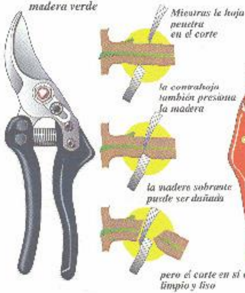
Podadera tipo destizante (bypass) para corte de madera verde
