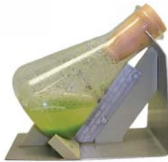
Dispositivo para medir el VSC. El ángulo de 60^\circ maximiza la altura de las células sedimentadas (para erlenmeyer de 250 ml). Tomado de Mustafa et al., 2011 (Nature Protocols 6:715).
