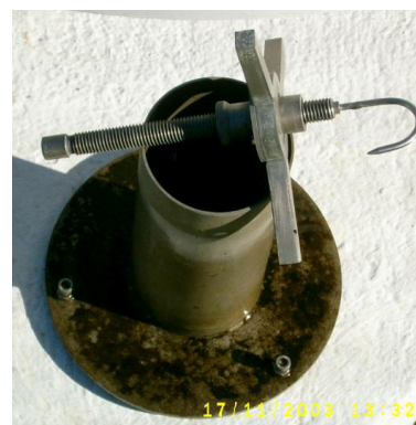
Foto 2. Tanque clase A rodeado de cubierta verde y detalle del tornillo micrométrico e indicador de anzuelo.
